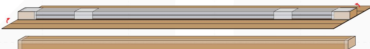
5. 如果型材数量较多，把上一步包好的型材组件4捆放到一起再次打捆，在外面加两根L形纸护边(防弯)，裹缠绕膜，打打包带，贴标签；
