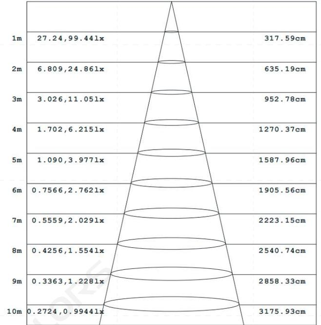
高度 Eavg, Emax 光束角: 115.60度 直径
